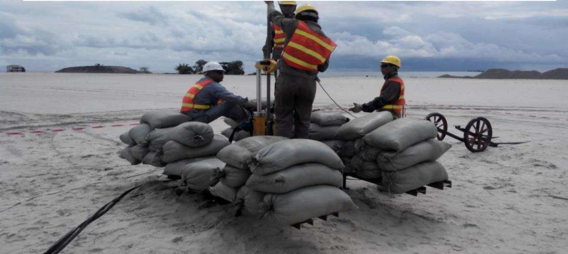
Tests de pénétration des cônes
